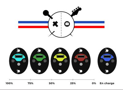
**START:** Branchez le jack, un clic sur le bouton permet d'allumer le B.M.S et de voir le montant de batterie restant.
